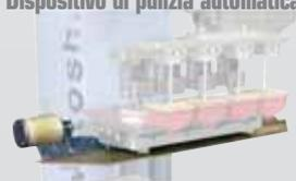
Permetta di effettuare un ciclo di pulizia tamponi con frequenza di intervento programmabile.
